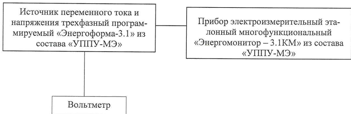
Рисунок 4 - Схема подключения для определения погрешности измерений напряжения переменного тока
